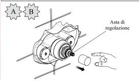
Rimuovere la protezione in plastica senza ruotare l'asta di regolazione brocciata
