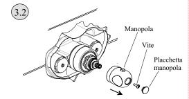
Togliere la placchetta, svitare in senso antiorario la vite e rimuovere la manopola di regolazione
