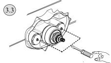
Chiudere le acque serrando in senso orario le viti situate sui tappi delle valvole non ritorno con un cacciavite a taglio
